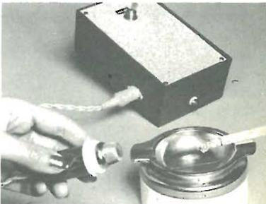
L'olfatto dei transistor alla ricerca delle fughe di gas. Un dispositivo utilissimo per la sicurezza.
